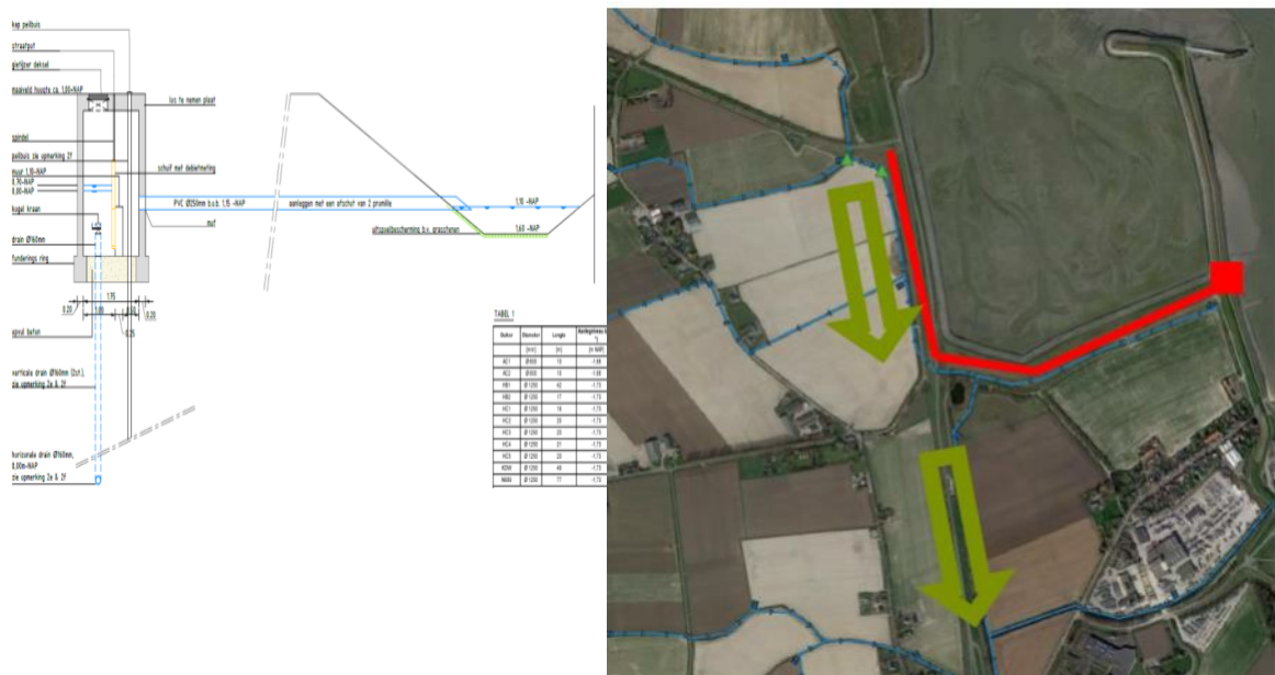
Figuur 12, Schematische weergave van de maatregel "drainage". De groene pijlen geven de afvoer van regenwater uit het gebied aan.
