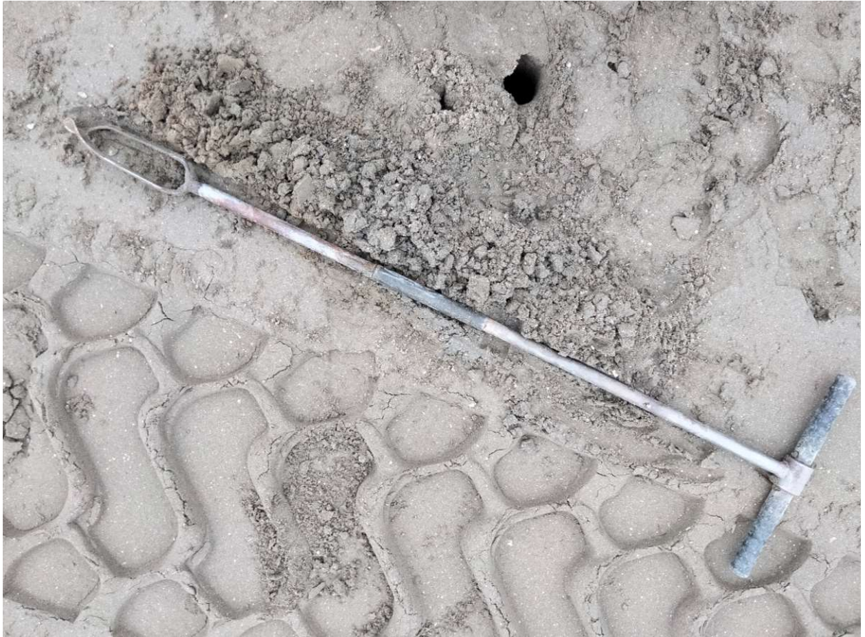
Foto 5 profiel recent aangebrachte laag zand, dikte circa 0,7 meter
